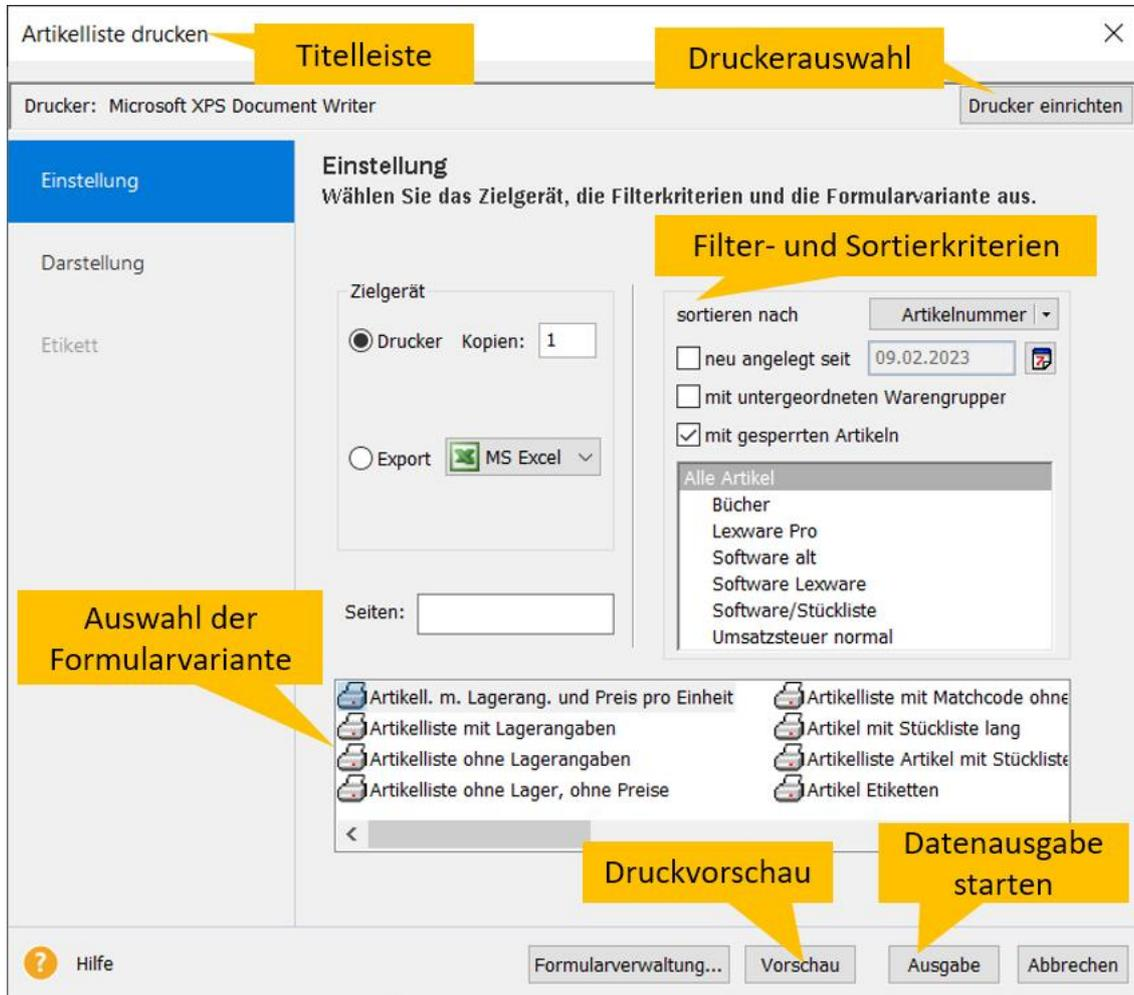
Über die **Auswahlleiste** wechseln Sie zwischen den vorhandenen Seiten. An der **Titelleiste** können Sie ablesen, welche Daten ausgegeben werden.
